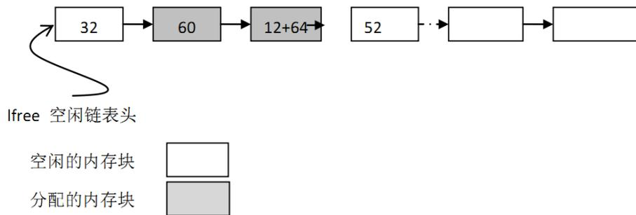
图 5.4: 分配64字节后的链表结构
