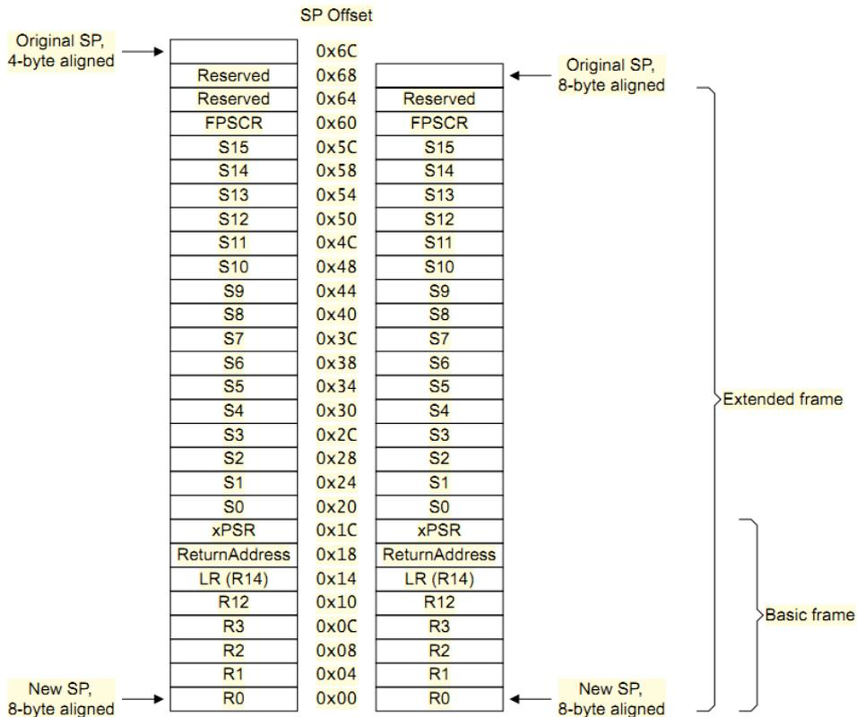
图 9.17: 启用FPU后自动入栈顺序图
