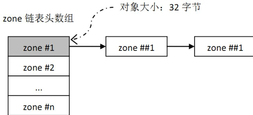
图 5.5: SLAB 内存分配器结构
