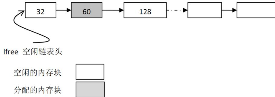
图 5.3: 小内存管理算法链表结构示意图
